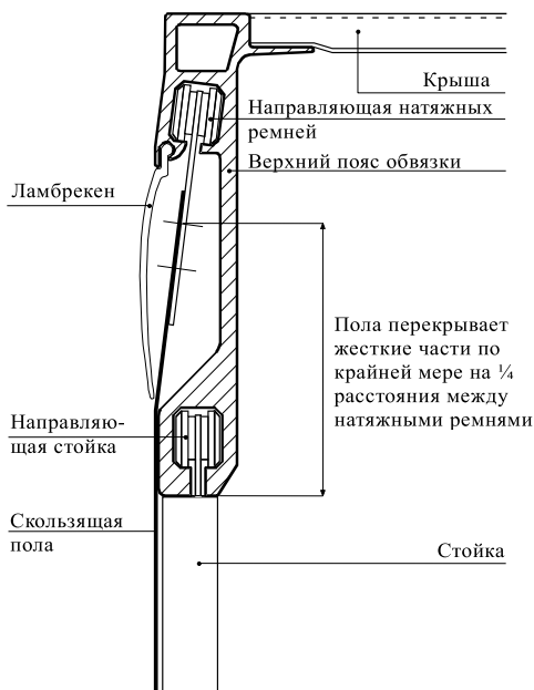
Рисунок 9.2 НАПРАВЛЯЮЩИЙ ЭЛЕМЕНТ И ПЕРЕКРЫТИЕ СКОЛЬЗЯЩЕЙ ПОЛЫ – ВЕРХ
